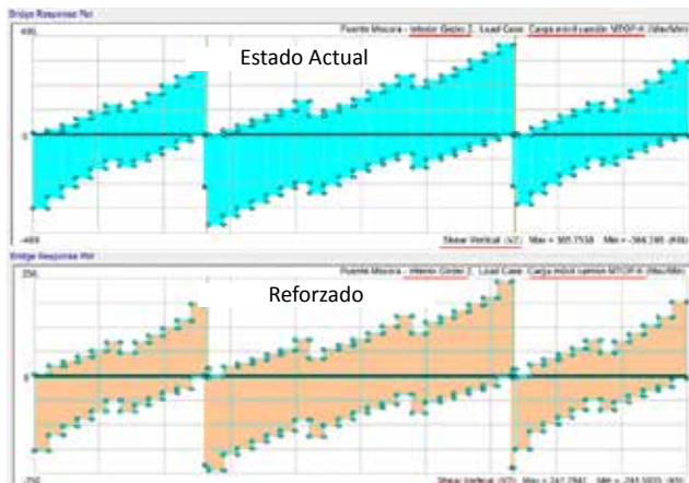
Figura 238. Diagramas de fuerza cortante para vigas interiores debido a carga móvil HS-MTOP
