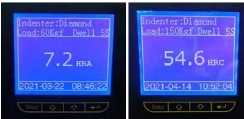
Figura 11. Medición de la dureza superficial a) estado de suministro, b) experimento 11
