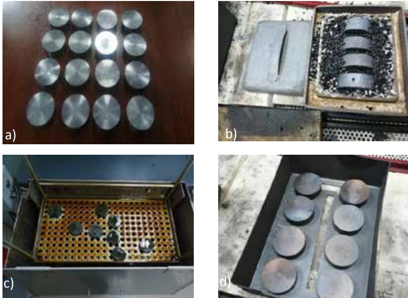
Figura 10. Probetas a) material de suministro, b) después de la carburación, c) después del temple, d) después del revenido
