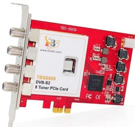
Ilustración 16. Tarjeta TBS6909 DVB-S2 como codificador de señal de antenas satelitales
